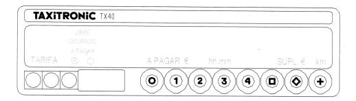
Tassametro in ON premendo il tasto **O** . Se si e programmato un codice di accesso, si accendera il primo punto decimale del display dell' importo, indicando che si aspetta l' introduzione del codice corretto.
